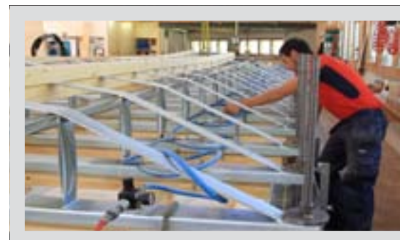
Die Pressrahmen werden in Serie an Pressluft angeschlossen. Sie verfügen unten über einen Pressaufsatz der diese in bis zu 4t Presskraft pro Rahmen umwandelt. Dabei wird der Druck über ein Ventil geregelt.
