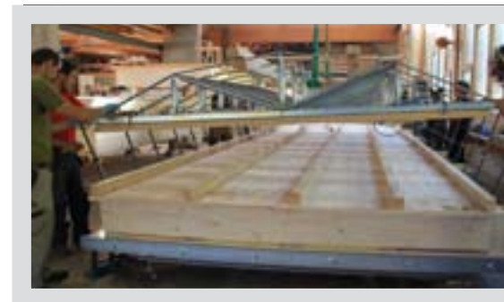
Die Pressrahmen werden aufgesetzt und mittels Zugstangen im Lochraster des Elementbauteschusses befestigt.
