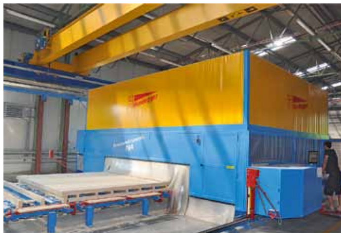
Das CNC-Portalbearbeitungszentrum formt die BSP-Platten bis zu einer Länge von 12 m
