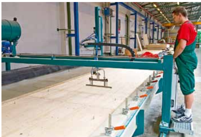
Ein verringerter Leimbedarf und eine verbesserte Oberflächenqualität werden durch die Fankhauser-Vakuumpresse erreicht
