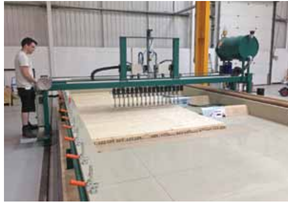
Produktion von Brettsperrholz: Klebstoffauftrag mit 100 mm breiten Einzeldüsen
