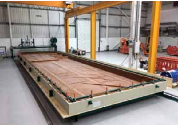
Wie hier am Innovation Center in Schottland, wird die Woodtec-Vakuumpresse von vielen Klein- und mittelständischen Unternehmen eingesetzt, um BSP selbst herzustellen
