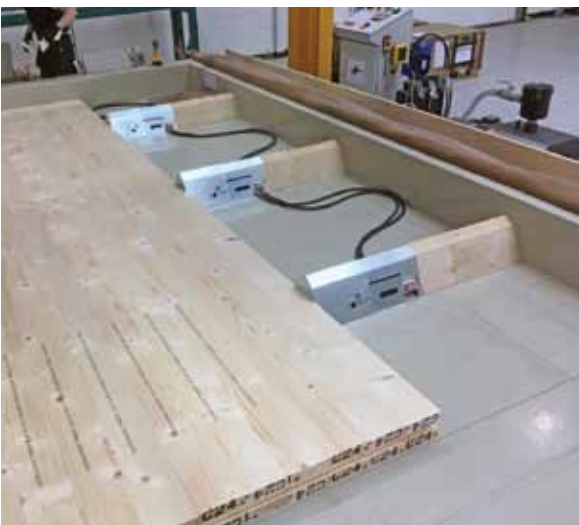
Die Lamellen werden mit hydraulischen Zylindern quergepresst
