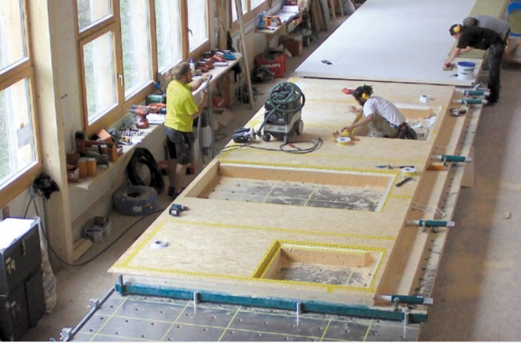
links: Bei der Künzli Holz AG ist man nicht nur von der Präzision des Elementbautisches überzeugt, sondern auch von der Effizienz die dieser ermöglicht. rechts: Dank der Dachvorrichtung können auch Dach- und Deckenelemente in Serie auf dem Elementbautisch vorgefertigt werden.
