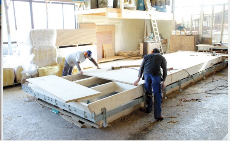
links: Bei der Künzli Holz AG ist man nicht nur von der Präzision des Elementbautisches überzeugt, sondern auch von der Effizienz die dieser ermöglicht. rechts: Dank der Dachvorrichtung können auch Dach- und Deckenelemente in Serie auf dem Elementbautisch vorgefertigt werden.
