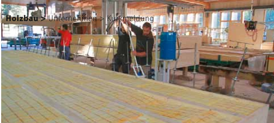
Der Klebstoffauftrag auf den Stegen wurde neu konzipiert, was kritische Minuten erspart
