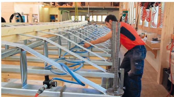
▲ (li.) Die pneumatische Pressvorrichtung ermöglicht das Verleimen von Hohlkästen und Rippendecken, die eine erhöhte Tragfähigkeit besitzen
