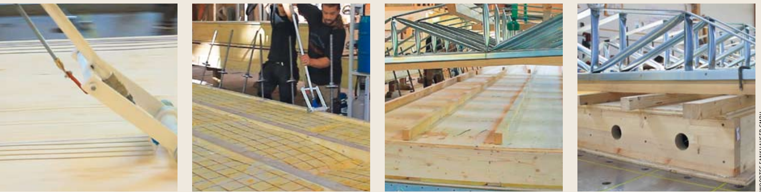
▲ Ein Trend für die Zukunft: Verleimen und Pressen von Kastenelementen auf dem Elementbautisch mit neuem Handklebstoffauftrag und Pressvorrichtungen
